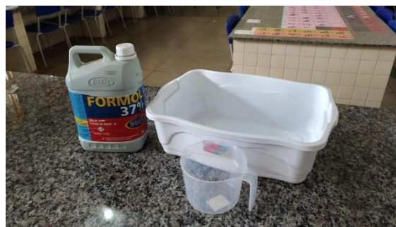
Figura 13 - Materiais necessários para diluição do formol. Um recipiente para manter a solução e outro recipiente graduado para fazer a medição exata do formol e da água.
