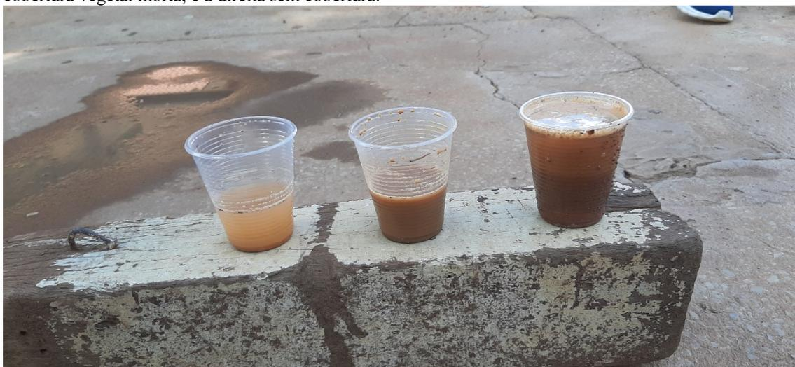
Figura 8e. Resultado do experimento no qual pode-se observar a quantidade de solo perdida/carregado pela chuva, durante a experiência. Na esquerda o resultado do solo com cobertura vegetal viva, no meio com cobertura vegetal morta, e à direita sem cobertura.
