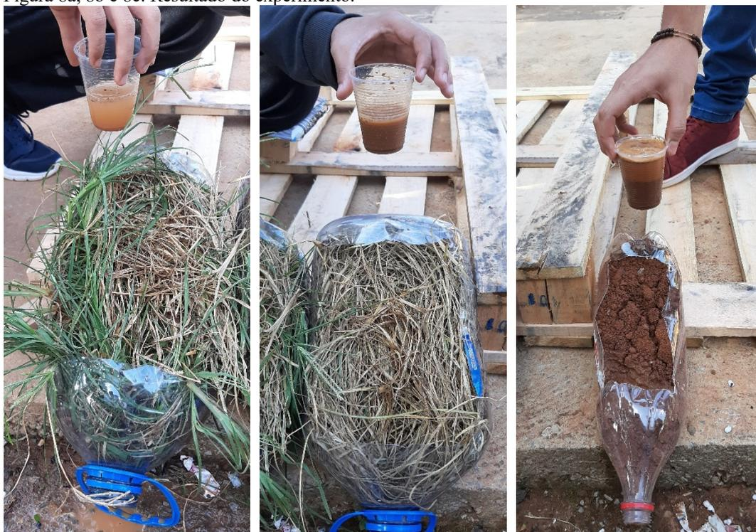
Figura 8d. Resultado do experimento no qual pode-se observar a quantidade de água perdida coloração da água e se há ou não perda visual de solo. Na esquerda o resultado do solo com cobertura vegetal viva, no meio com cobertura vegetal morta, e à direita sem cobertura.
